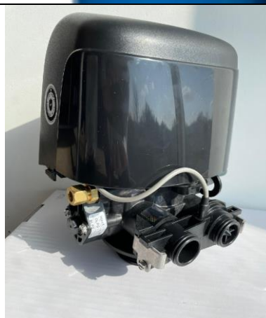
Foto 5 – De achterkant van de stuurklep met de ijzeren klemmen. Verwijder deze klemmen, monteer de bypass en verbind de klemmen weer op hun plaats.
