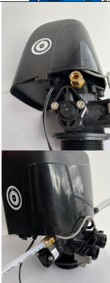
Foto 13 – Resultaat van het verbinden van de adapter met de stuurklep. De aansluiting zit verdacht
